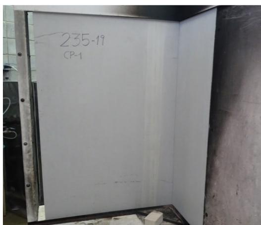
Foto 6 – Disposição do corpo de prova no carrinho de ensaio.
